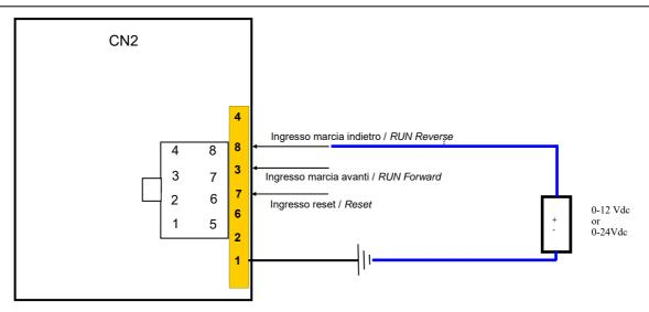
In alternativa al comando con relé o interruttore presentato a pag.5 è possibile comandare gli ingressi digitiali (3,7,8) con un segnale esterno analogico 0-12Vcc oppure 0-24Vcc. Il valore di riferimento è da collegare al pin 1.
