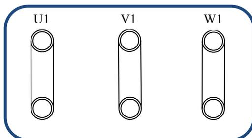
Nel caso del motore serie TS, la sequenza CN2 → 1 = U1, 2 = V1, 3 = W1, la selezione della marcia avanti si riferisce al senso orario riferito all'albero motore.
