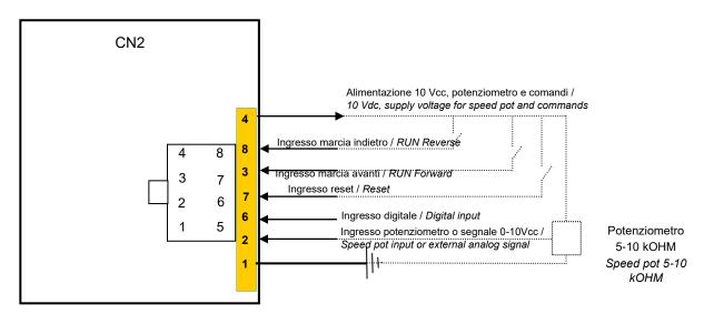
Pin 5: ingresso ausiliario analogico (solo versione Option) / Pin 5: auxiliary analogue input (only option version)
