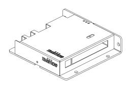
Il presente manuale descrive l'uso delle schede a modulazione PWM denominate PLN20 e PLN40: azionamenti bidirezionali per motori a CC a magneti permanenti a bassa tensione. Tensione di ingresso da batteria o alimentatore stabilizzato. Tensione di uscita modulabile per la selezione della velocità del motore, comando e selezione della direzione, dotazione di rampe e di limite di corrente.
